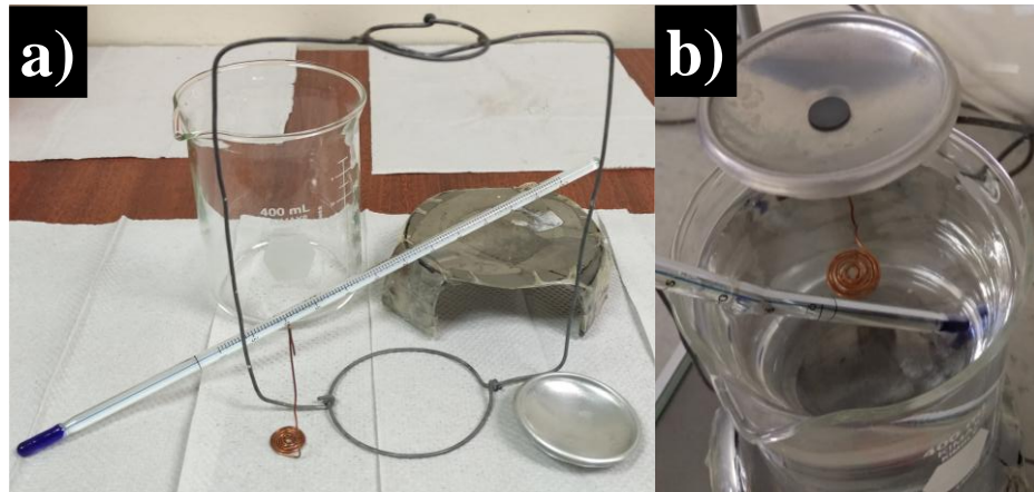
Figura 3.13 a) Componentes de aparato de medición de densidad de Arquímedes y b) obtención de peso en seco de cerámica representativa.
