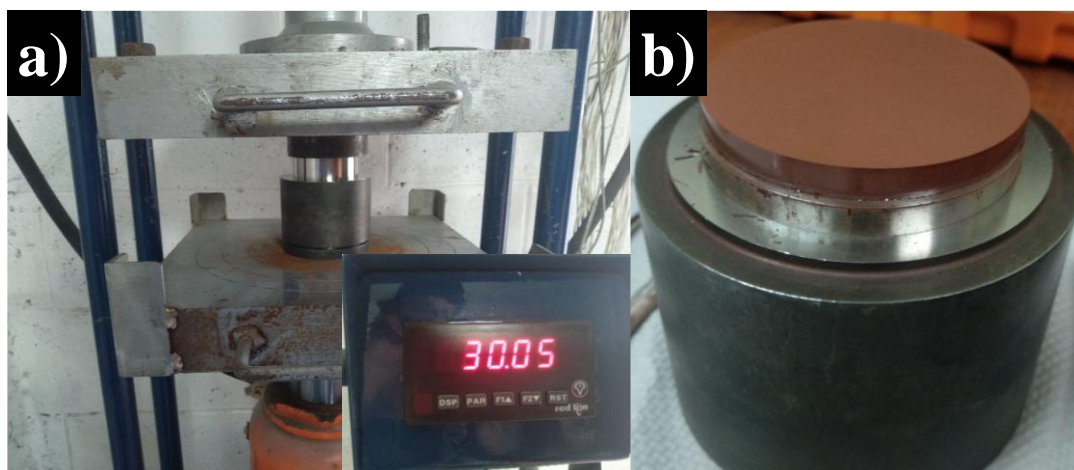
Figura 3.5 a) Compactación de polvos molidos en dado de 2.5" y b) polvos conformados.
