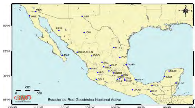
Figura 16. Estaciones GNSS de monitoreo continuo.
