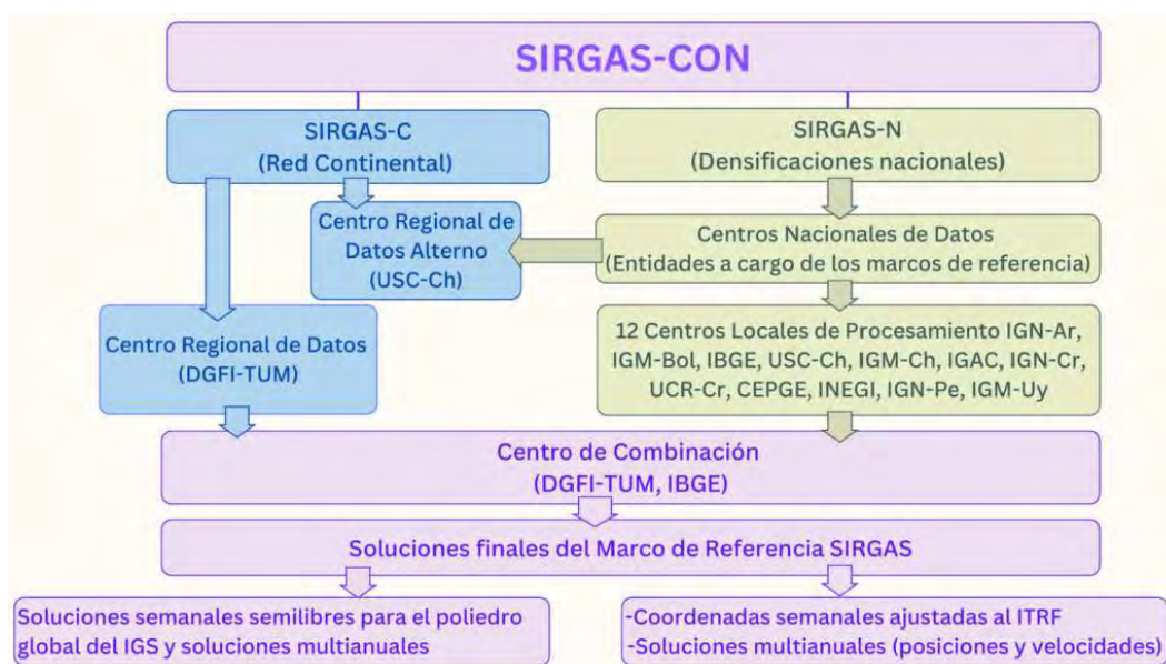
Figura 4. Centros de análisis y combinación de la red SIRGAS-CON (Sánchez et al., 2013).
