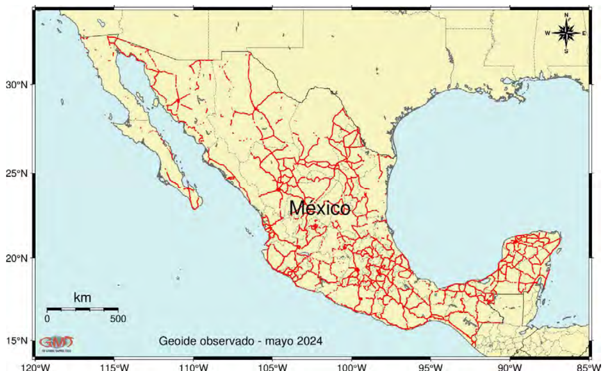
Figura 27. Vértices de geoide observado (calculado a partir de altura elipsoidal y altura ortométrica).
