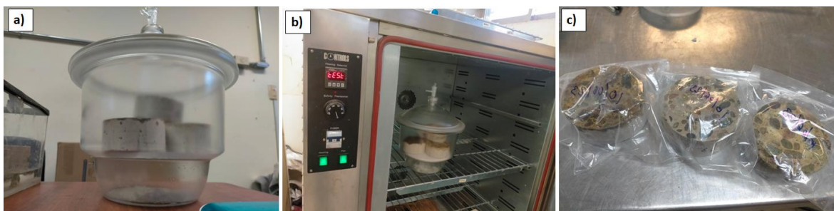
Figura 3-7. Acondicionamiento de especímenes para la prueba de velocidad de absorción de agua del concreto hidráulico (ASTM C1585-20). a) Colocación de especímenes en desecador con KBr, b) Desecador con especímenes en horno de secado a 50°C durante 72 h y c) Especímenes acondicionados almacenados en bolsas de plástico por 15 días.
