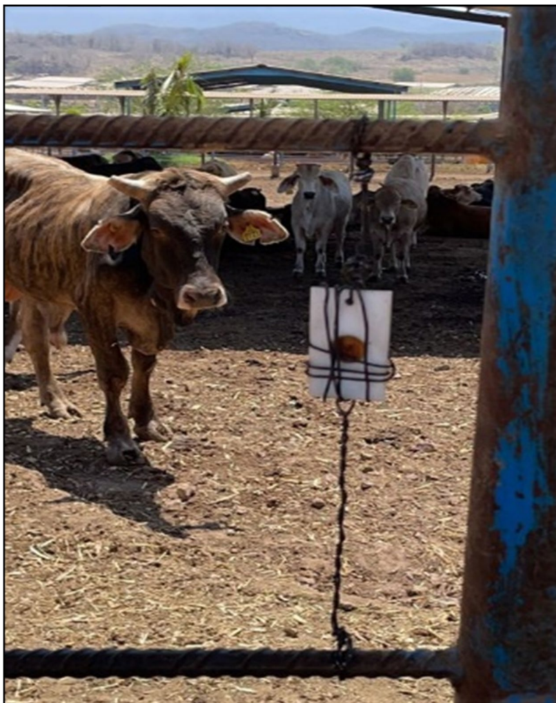
Figura 18. Termohigrómetro colocado en el corral central a 1 m de altura.
