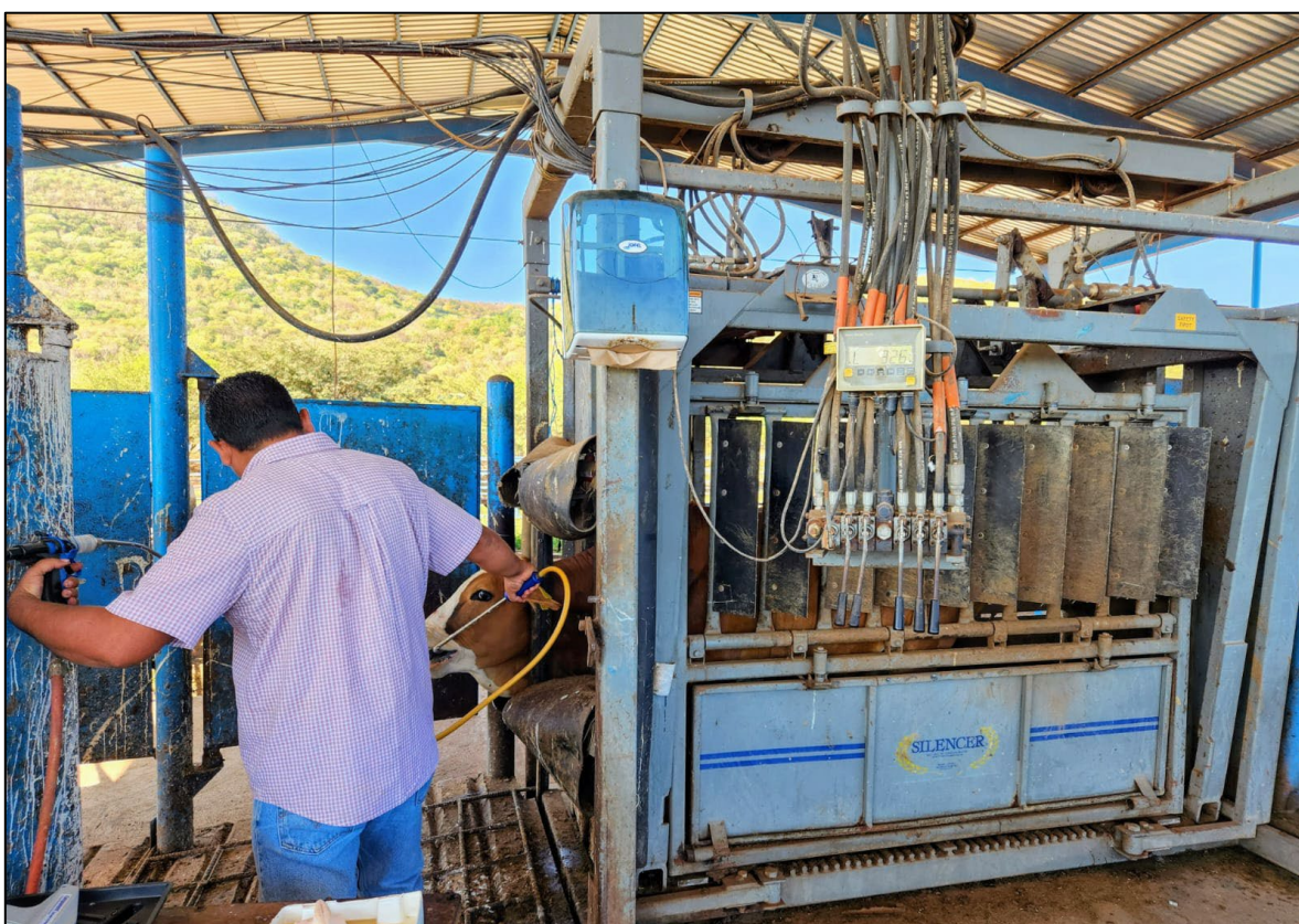
Figura 16. Prensa hidráulica utilizada para el pesaje y manejo de los animales.
