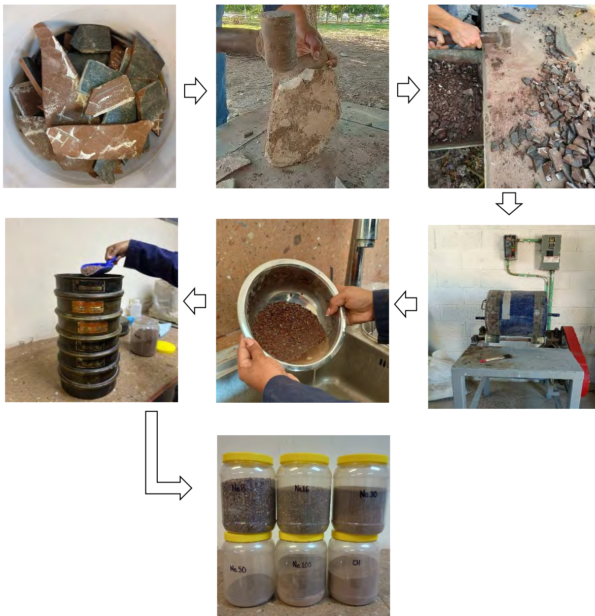
Figura 10. Proceso de reciclaje del cerámico residual: a) acopio del material, b) selección y limpieza, c) trituración con marro, d) trituración con molino, e) lavado del material triturado, f) tamizado del material triturado y g) almacenamiento del material cerámico.
