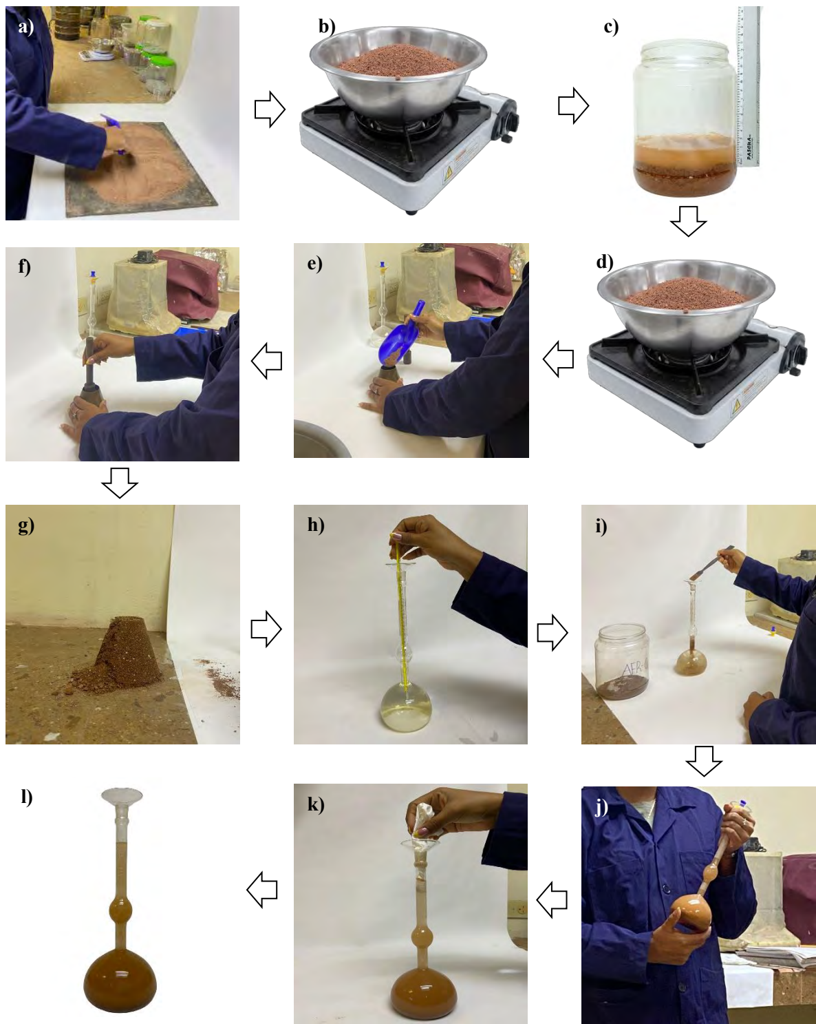
Figura 17. Proceso para obtener valores de densidad y absorción de los agregados basado en la norma ASTM C128.
