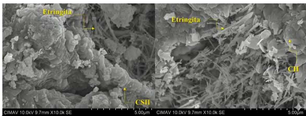
Figura 3. Micrografías de SEM a 10,000x de una pasta de cemento; se observan los principales productos de hidratación del cemento [15].
